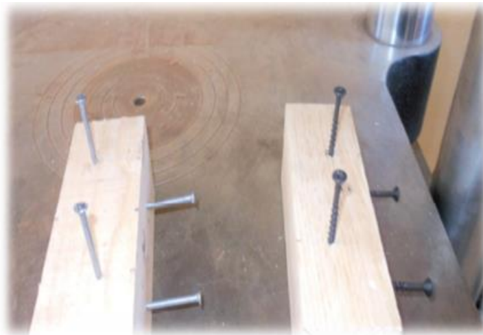
Fig. 4. Representación de la colocación de los clavos para realizar el ensayo de extracción
