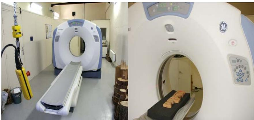
Las muestras fueron estabilizadas hasta el estado de humedad "seco al aire" gracias a su larga estancia hasta peso constante en la sala del escáner, lo que corresponde a un estado de humedad de la madera de 12% aproximadamente, para la medición de la densidad con el escáner se siguió el procedimiento descrito por Freyburger *et al.*, (2009).
